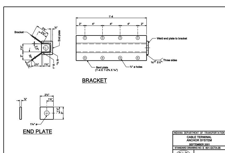
**GUARDRAIL ANCHOR BRACKET**
