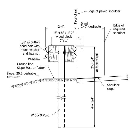
TYPICAL DOUBLE FACED W-BEAM INSTALLATION
