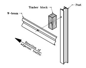
$\frac{\text{W-BEAM SPLICE CONNECTION}}{\text{DETAIL AT POST}}$
