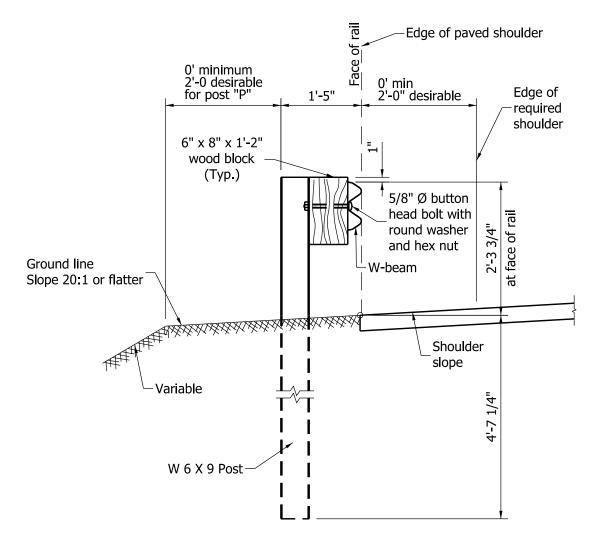
TYPICAL W-BEAM INSTALLATION
