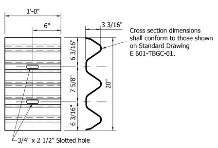
THRIE BEAM GUARDRAIL BACK-UP PLATE
