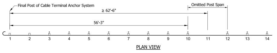
MINIMUM DISTANCE BETWEEN OMITTED POST AND MGS CABLE TERMINAL ANCHOR SYSTEM
