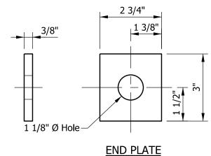
**GUARDRAIL ANCHOR BRACKET**
